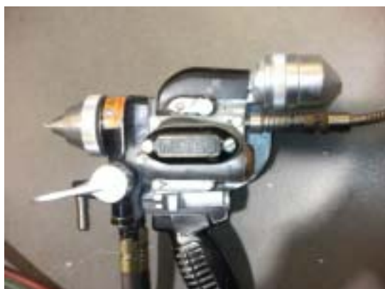
図5 ローカイド・スプレー溶射器の射出ノズル
