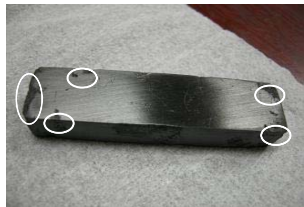
図5 自作の墨 白丸で囲んだエリアは磨き残し
