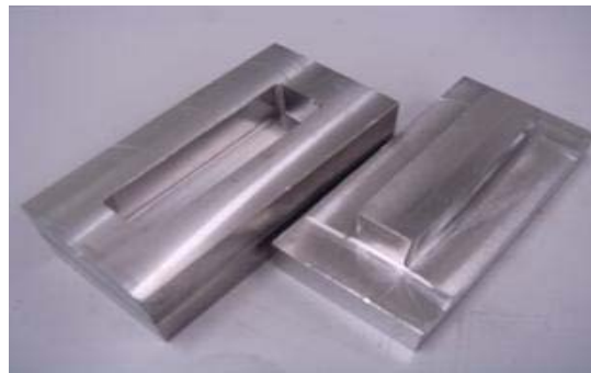
図1 ステンレス製金型 金型サイズ : 縦23 mm x 横87 mm x 深さ20 mm
