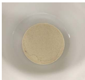
図2 錠剤化したかんぴょう粉末試料 (直径15mm, 厚さ2mm)
