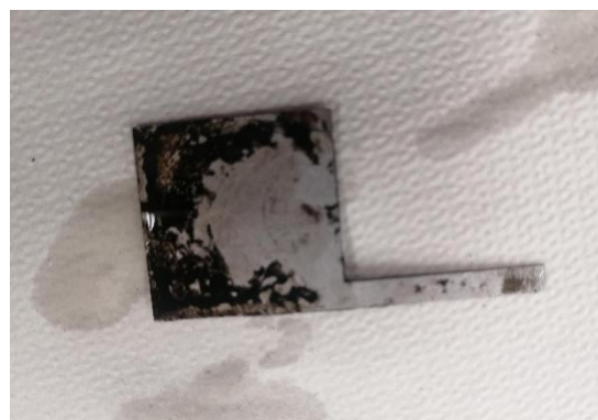
Fig. 3 樹液に 2 日間浸漬後の錆サンプル
