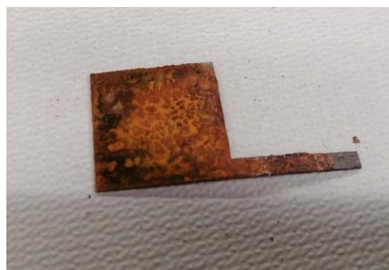
Fig. 2 作製した錆サンプル(樹液浸漬前)
